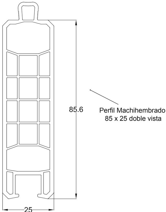
Este perfil de PVC que permite conformar paneles de doble vista para su aplicación universal en puertas de acceso y de garaje enmarcadas en perfiles de PVC, madera, aluminio o hierro.
