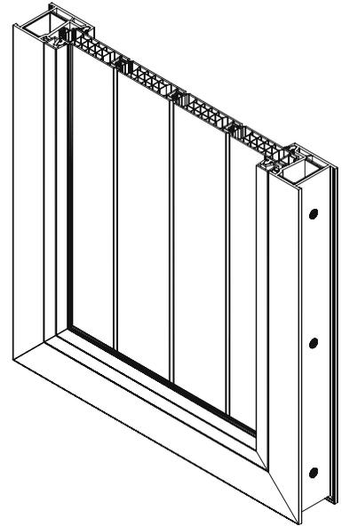
**Panel de PVC Machihembrado
